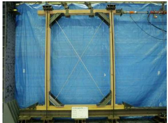
ウッドピタ水平ブレースの耐力検証実験の様子
